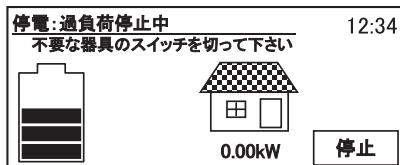
消費電力の合計が定格 3kW 以上になると再起動となります。再起動を 2 回行っても消費電力が定格 3kW 以上だった場合、アラームが鳴り、自立運転が停止し、停電となります。(過負荷停止中)
