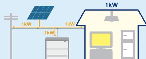
ご家庭でご使用の電気が1kW、太陽光が3kW発電している場合、太陽光で発電された電気は1kWをご家庭の電気に供給し、リチウムイオンバッテリーシステムが満充電でない場合は、電池へ充電を行います。電池が満充電になつた場合、余った電気は電力会社へ売電を行います。
