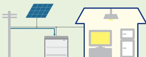
深夜電力(電力会社)からの電気でリチウムイオンバッテリーシステムへ充電を行います。
