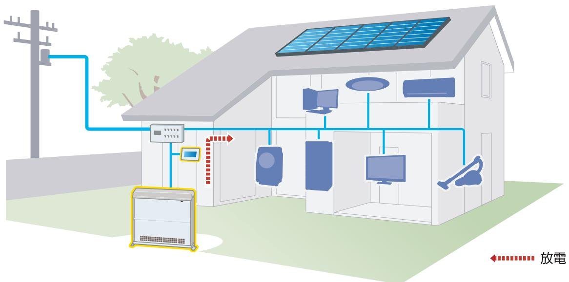
**自立運転状態 :** 電力会社からの電気がストップした場合、太陽光発電の電気を充電しながら、本システムのバッテリーを使用している状態
