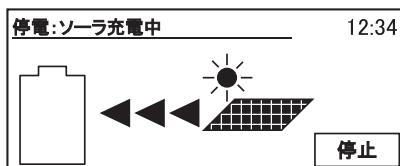
深夜電力モード、フルコントロールモードとともに停電時には自立運転モードに移行し、太陽光発電が 800W 以上発電していれば、800W で充電することができます。
