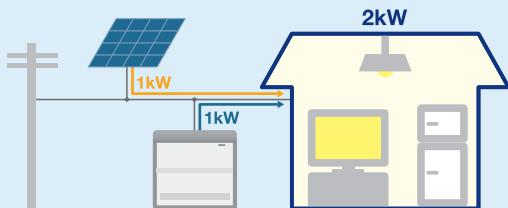
ご家庭でご使用の電気が2kW、太陽光が1kW発電している場合、太陽光で発電された電気は1kWをご家庭の電気に供給し、リチウムイオンバッテリーシステムより不足分の1kWを放電いたします。
