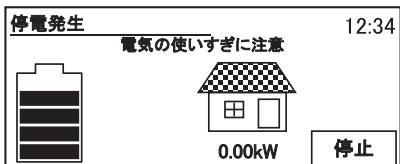
停電したことを知らせるために、ブザー音（ピーピー）が鳴ります。画面を押すとブザー音が停止します。
