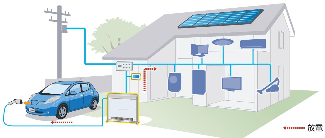
**自立運転状態 :** 電力会社からの電気がストップした場合、太陽光発電の電気を本システムに充電しながら、本システムのバッテリーを使用している状態
